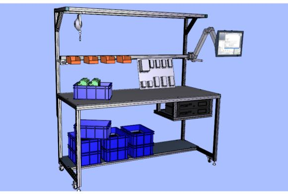
L'étude et la réalisation des plans de détail d'un poste de travail de ce type pourront être confiées à un dessinateur maîtrisant les bases de la conception en 3D. Cet assemblage a été réalisé avec le logiciel **Inventor 2008** de l'éditeur **Autodesk** (**www.autodesk.fr**). Cliquez sur le modèle pour passer en mode 3D. Essayez les différentes vues proposées et lancez l'animation à l'aide de la touche
